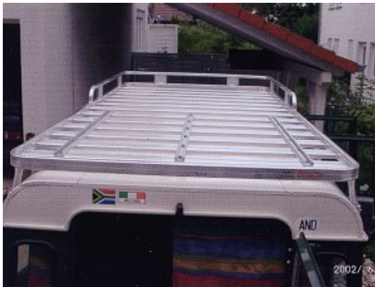
Montierte Profilschienen. Der Abstand der beiden äußeren Schienen beträgt auch hier 1015 mm, damit sie die Leisten des Zeltes aufnehmen. Dort werden jetzt die Löcher (insgesamt 4) gebohrt. Die mittlere Schiene dient nur als Stütze für den Zeltboden. Das Zelt wird dann von hinten auf den Träger gehoben und die 4 "Schlitten" mit den Schrauben in die Löcher eingefädelt.
