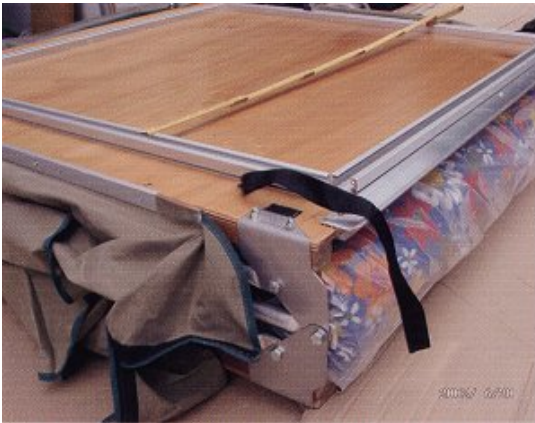
Gelenkteil der Zeltkonstruktion. Der Abstand der beiden Leisten beträgt hier genau 1015mm. Man beachte das modische Blümchenmuster der Matratze aus den 70ern!
