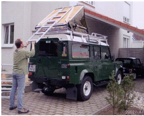
Mit der herausgeschobenen Leiter wird das Dachzelt auseinander geklappt und in die Endlage gebracht...
