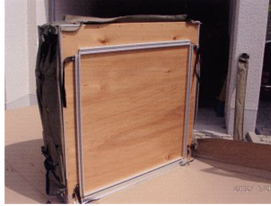
Unterseite des zusammengefalteten Dachzeltes. Die beiden senkrechten Leisten dienen zur Befestigung auf dem Träger.
