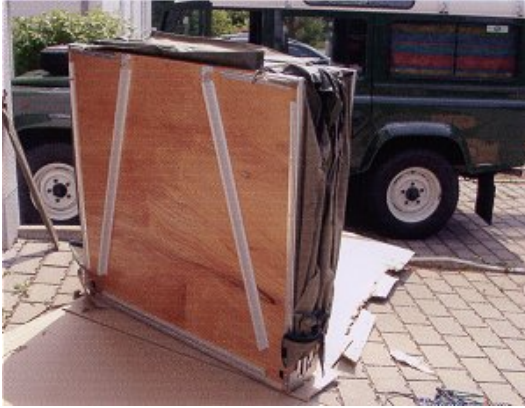
Oberseite des zusammengefalteten Dachzeltes. Zwischen den schrägen Leisten liegt später die Leiter.
