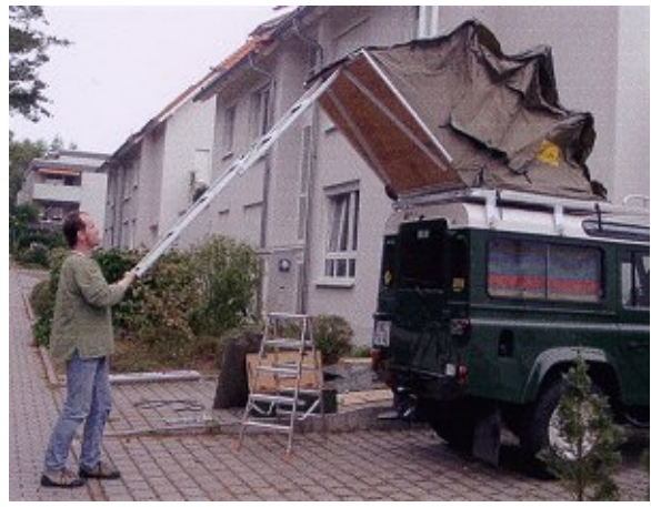
Mit der herausgeschobenen Leiter wird das Dachzelt auseinander geklappt und in die Endlage gebracht...
